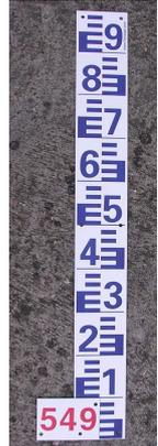
*Action possible : Pose d'échelle(s) limnimétrique(s) pour améliorer l'alerte*
