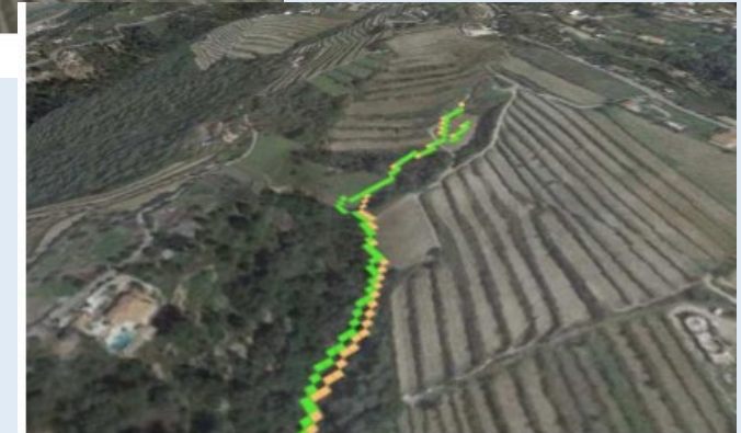
Figure 2: Le calcul de thalweg est un peu différent car le MNT a été modifié
